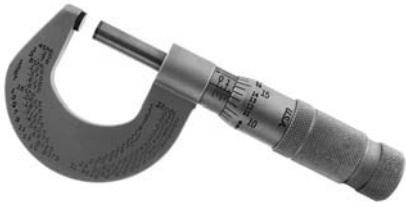
FIGURA 1.4 El micrómetro se utiliza para medir el tamaño de los objetos con una gran precisión. El objeto que hay que medir se coloca en la abertura, girándose la rueda de la derecha hasta que el objeto quede firmemente asegurado. Entonces, la escala numérica indica la longitud del objeto, normalmente con una precisión del orden de 0,01 mm.
