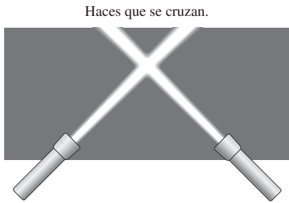
FIGURA 22.1 Los haces de luz incoherentes pasan uno a través del otro sin que se produzca ninguna interferencia apreciable.
